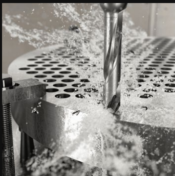
Den utbytbara borrar CoroDrill® DE10 är utformad för hållborrning i stora volymer med smidig plug-and-play-funktionalitet.
