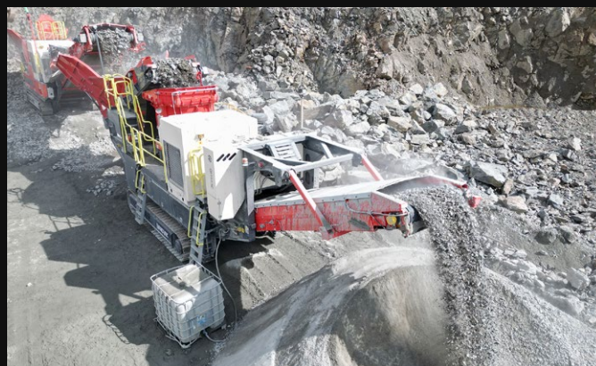
En ny elektrisk konkross, QH443E, överbryggar klyftan mellan banddrivna mobila, hjulburna portabla och stationära anläggningar genom att kombinera eldrift och banddrift på en och samma plattform.
